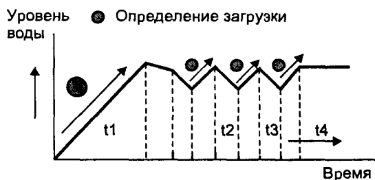
Рис. 3.17.28. Определение машины степени загрузки бграбанг бельем
